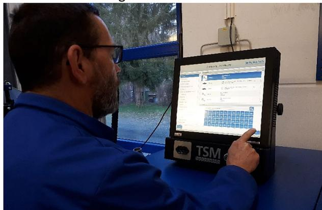
**Abb. 1:** Benutzeridentifikation und Werkzeug-/ Bauteil-auswahl am Access Frontend
