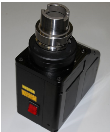
Abb. 1: Laser-Triangulations-Messkopf mit Schnittstelle (HSK63) zur Maschinenspindel
